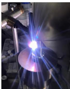
Essai d'extraction dans le four à induction
