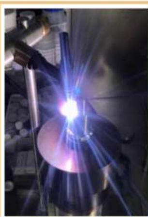
Essai d'extraction à chaud dans le four à induction
