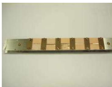
Figure 34 : Porte objet utilisé pour 10 échantillons pour des mesures SPX
