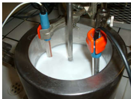
Figure 41 : Cuve comprenant les sondes de pH et de conductivité
